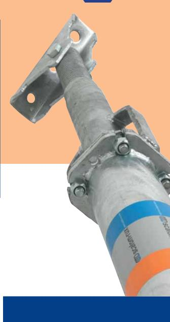
Los puntales roscados 38RL son un tipo de "puntales de rosca" que se utilizan para apear elementos y servir como soportes en la construcción de infraestructuras de servicios, carreteras y canalizaciones de agua (en este caso, desde una altura media hasta prácticamente 4,0 m). Los puntales pueden estar sometidos a fuerzas de tracción y compresión y tienen una longitud de ajuste de 60 cm.
