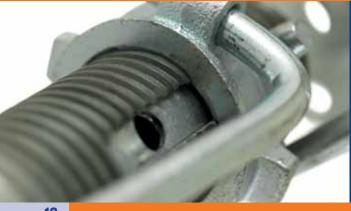
Los puntales roscados de peso intermedio del tipo EP20 son apropiados para soportar desde un mínimo de 20kN en cada tramo extensible, variando ésta desde 1500 hasta 5500 mm. El puntal está provisto de una rosca exterior para una instalación segura y tiene placas de base y de cabeza planas para su utilización en combinación con sistemas de encofrados o con horquillas. Los puntales EP-20 pueden montarse en dos sentidos; con el tubo interior hacia arriba o con el tubo interior hacia abajo.
